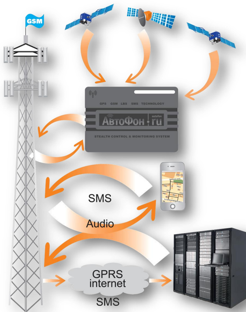
Рисунок 1 - Схема работы системы «АвтоФон КСА»
